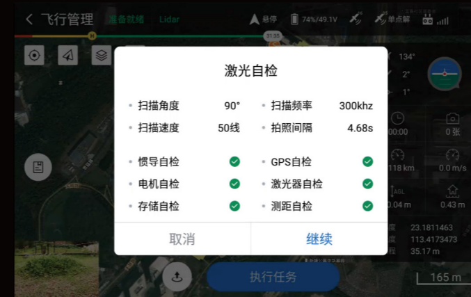
c. 起飞前自动进行激光自检和惯导初始化（无须飞八字）。
