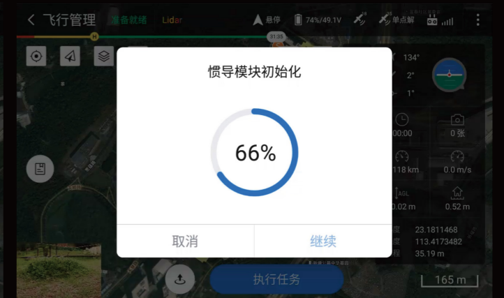
c. 起飞前自动进行激光自检和惯导初始化（无须飞八字）。
