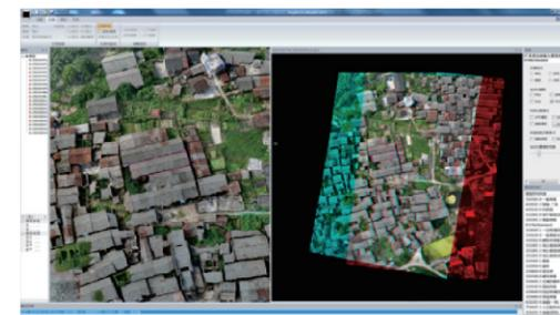
在DOM/DSM叠加的三维模型中绘制DLG
