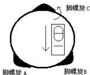
③再次旋转仪器  $90^\circ$  , 重复步骤①、②, 直到四个位置上气泡居中为止。
