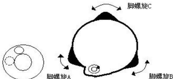
②旋转脚螺旋 C，使圆水准气泡居中。
