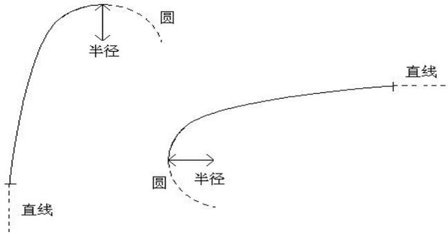
在主线输入过程屏幕中按`缓曲`键，便可以定义缓和曲线。缓和曲线包括最小半径和弧长。其半径正负的规定和圆半径的正负的规定一样。同样，弧长也不能为负数。
