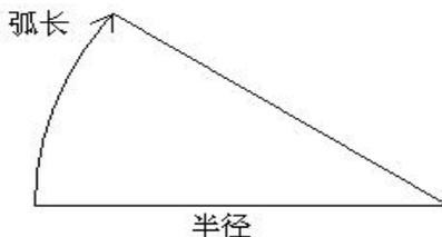
在主线输入过程屏幕中按 $\boxed{\text{圆弧}}$ 键，便可以定义圆曲线。圆曲线包括半径和弧长。半径值的规定为：沿着曲线前进的方向。当向右转弯时半径为正值，当向左转弯时半径为负值。弧长不能为负数。
