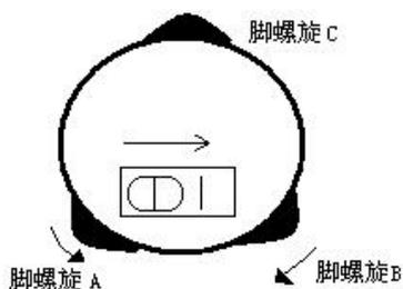
②将仪器绕竖轴旋转  $90^\circ$  , 再旋转另一个脚螺旋 C, 使管水准器气泡居中。
