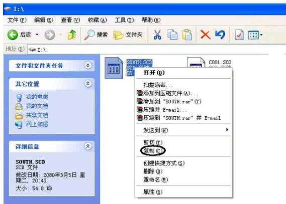
(5) 双击移动磁盘 H, 打开磁盘后, 右击鼠标, 在弹出的菜单中选择“粘贴”, 如下图所示进行传输文件。在弹出的菜单中还可以删除文件和编辑文件名。要返回数据通讯菜单, 在仪器上按[F4] (退出) 键, 断开电脑连接。
